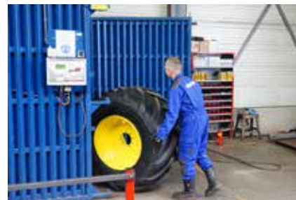
Afbeelding 12: bandenkooi. Bij een klapband wordt de vrijkomende lucht verspreid door de metalen profielen.
