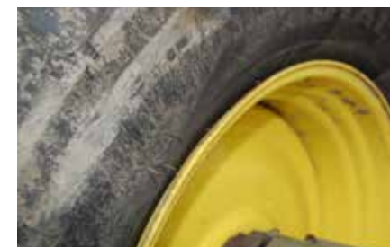
Afbeelding 15: hiel nog niet volledig gezet bij 1 bar voorspanning
