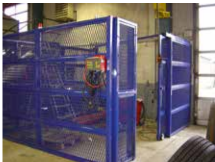
Afbeelding 11: kooiconstructie waarbij de band op het montageapparaat wordt opgepompt.
