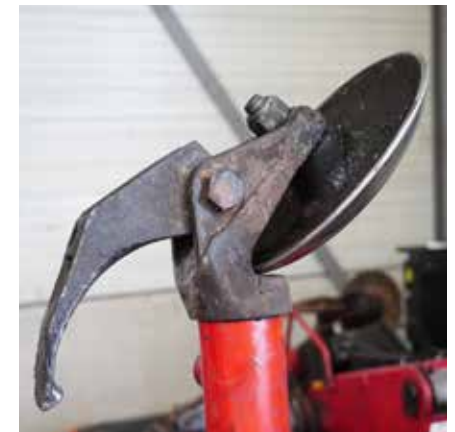
Afbeelding 7: (de)montagehaak (links) en montageschoel (rechts)
