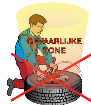
Afbeelding 21: leg een band nooit op de grond.
