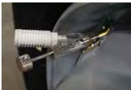
Afbeelding 10: geluiddemper bij het leeglopen van banden
