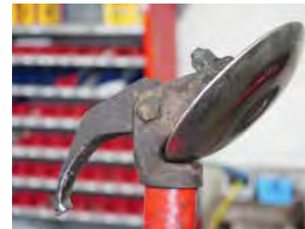
Afbeelding 11: (de)montagehaak met hielschotel
