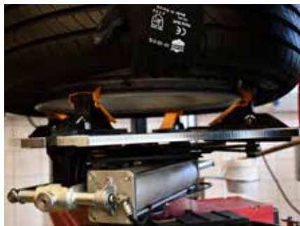
Stap 10 Span het wiel op het montageapparaat
