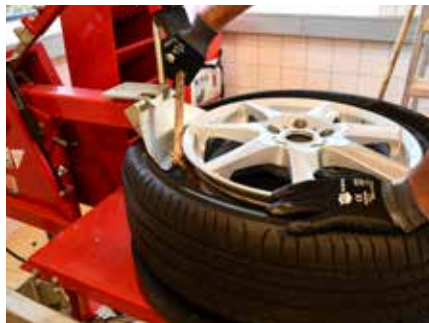
Stap 8 Gebruik bandenmontagepasta om de band van het wiel te demonteren
