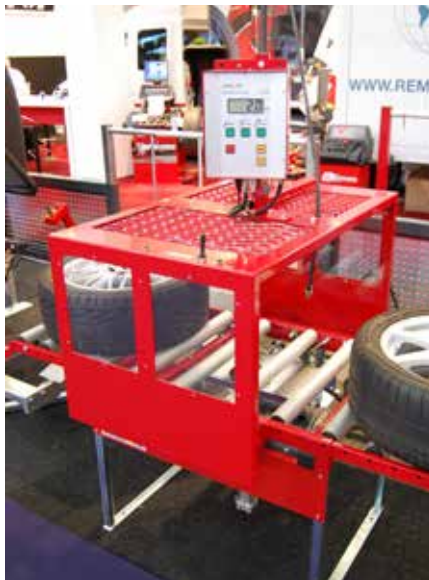
Montagestraat met pompklok en kooiconstructie
