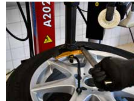
Stap 12 Plaats het ventiel bovenaan (op 12.00 uur)
