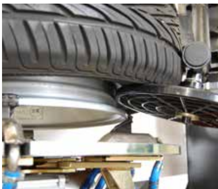
Hulparm houdt deel van de band omhoog bij het demonteren van de tweede hiel
