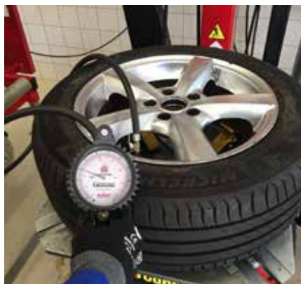
Maximale druk bij het zetten van de hiel van een personenautoband (zetspanning)
