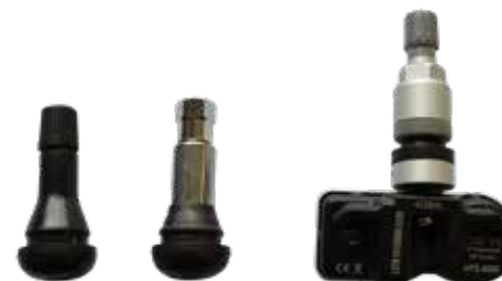
V.l.n.r. een rubber ventiel, een hogedrukventiel met metalen behuizing en een TPMS-ventiel
