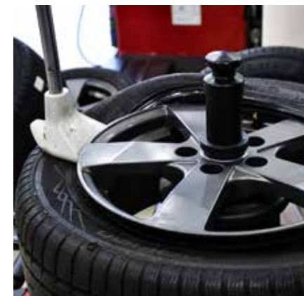
Hulparm om deel van de hiel in het diepbed te houden
