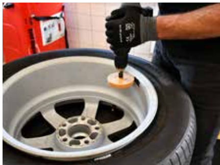
Stap 7 Verwijder het achtergebleven plak met een caramelschijf
