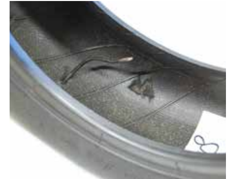
Band met spijker en karkasschade: altijd demonteren
