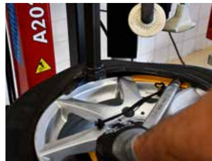
Stap 13 Laat de montagekop rustig met de klok meedraaien
